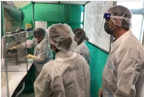
海底土試料について、乾燥器による乾燥、ヘラによる粉碎、2mm及び0.25mmのふるい分けを行った後、二分器による試料分割を行っている様子
