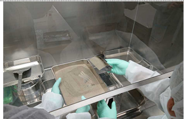
海底土試料について、乾燥器による乾燥、ヘラによる粉碎、2mm及び0.25mmのふるい分けを行った後、二分器による試料分割を行っている様子
