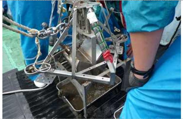
採泥器から海底土試料を取り出している様子 (\* 8日実施時の様子)
