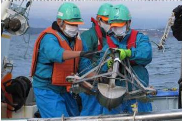
東京電力福島第一原子力発電所沖で海底土試料を採取しているところ (\* 8日実施時の様子)
